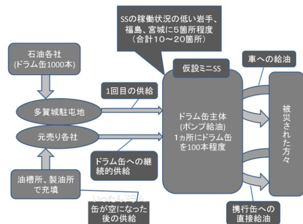
図 3 仮設ミニ SS の仕組み
